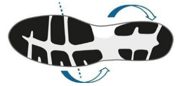
Figur 5. Sulan ska vara vridstyv.
